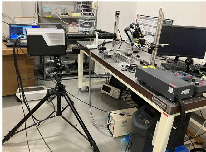
図1 開発した粒子射出法と高速度カメラによる粒子速度計測の様子
