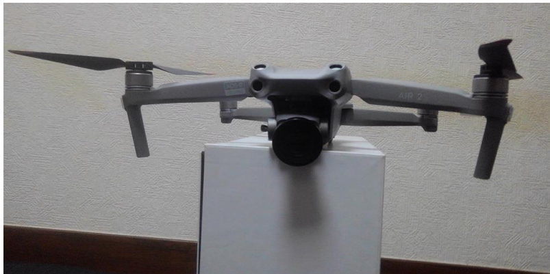
図2 開発したレンズ試作機のドローン装着時の写真
