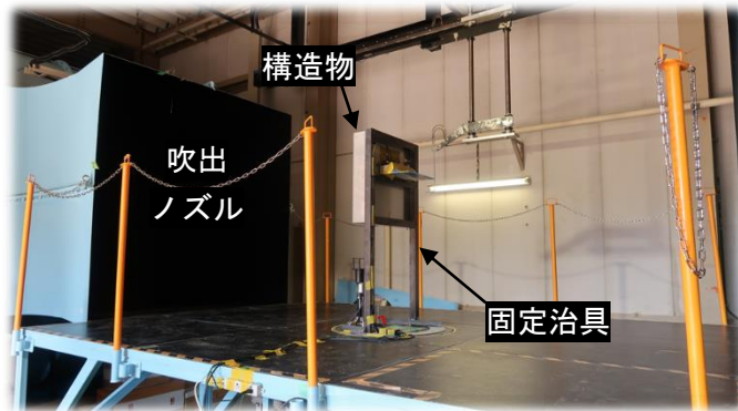
図2 風洞試験装置での計測実験
