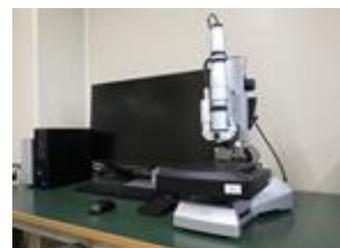
の画像の深度合成処理により被写界深度の深い全焦点画像が得られるため、立体的・緻密な製品の観察、解析、凹凸形状の3次元表示や表面粗さの計測も可能です。
