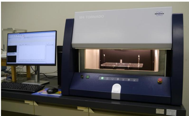
本装置は非破壊で元素分析を行う装置です。製品開発や品質管理等、幅広い分野で活用されています。従来機と比較して、試料高さ制限の緩和や高速分析、高速元素マッピングが可能となりました。
