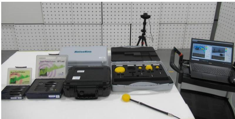
本装置は電磁界強度レベルを測定対象物の実画像と重ね合わせてヒートマップ状に表示する装置です。大小様々な計測用プローブを使用して、製品や電子基板の電磁界ノイズを可視化することで、ノイズの発生源・経路を確認できます。本装置により効率的なノイズ対策が可能で、主に電波暗室でのEMC試験対策に活用できます。
