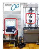
図1 疲労試験機（制御が更新部分）
