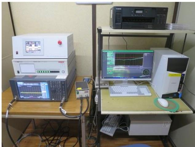
写真1 放射電磁波計測システム
