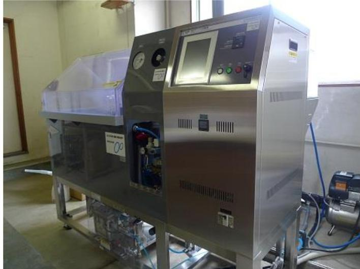
写真2 複合サイクル腐食試験機
