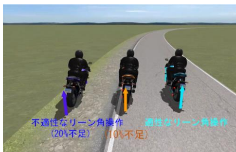
図3. リーン角による走行挙動の解析 <BikeSimによる解析>
