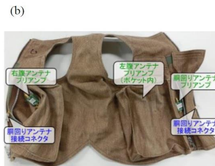
図3 (a) スマホサイズのポータブル受信器の試作品 (b) 導電性糸でループアンテナを形成したイヌ用ジャケット。
