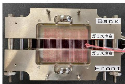
高温 (94~98°C) と低温 (55~60°C) に温調された流路を交互に高速に通過することで、従来方より安価で高速かつ温度のオーバーシュートが存在しないPCRを実現可能。PCR-on-a-Chip内部流体の温度を熱電対を用いて測定することで、サーマルサイクルの実現を確認した。
