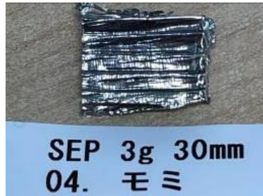
1. 25GPa水中衝撃波処理による針葉樹モミ ( Abies firma ) の衝撃成形レプリカ標本。アルミ使用。
