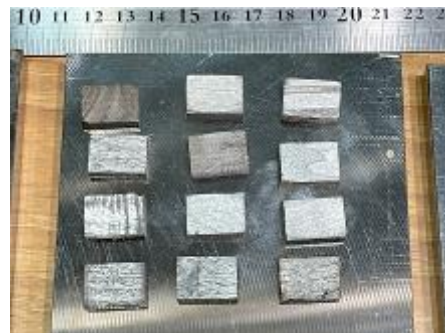
水中衝撃波処理による衝撃成形レプリカ標本作製実験（衝撃成形後）
