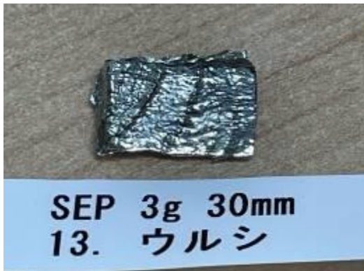
1. 25GPa水中衝撃波処理による落葉広葉樹ウルシ ( Toxicodendron vernicifluum ) の衝撃成形レプリカ標本。アルミ使用。
