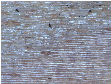
300MPa水中衝撃波処理による針葉樹トウヒ ( Picea jezoensis var. hondoensis ) の様子。本事業により導入したデジタルマイクロスコープによる撮影。
