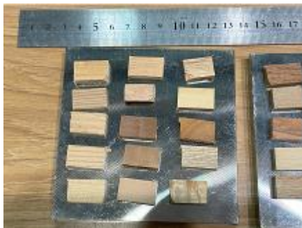
水中衝撃波処理による衝撃成形レプリカ標本作製実験（衝撃成形前）
