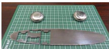
Fig.1 製造した合金インゴットと熱間圧延材(引張試験片切り出し)
