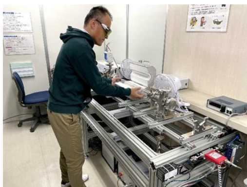
図 1 当研究室保有のレーザー蒸発法を利用する SWCNT 合成装置。
