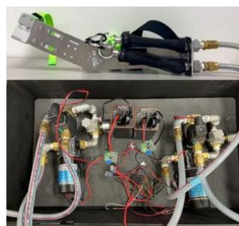
水圧駆動型駆動回路
