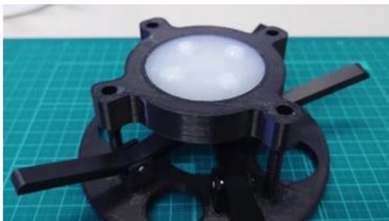
図1 舌運動を模擬する機構検討用のモデル
