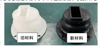
センサ基盤に関しては、既存のセンサを用いているため、センサ本体は防水構造となって おりません。そこで、ベローズの設置に加えて基盤上面をゴムで覆うように加工をすること で防水化の付与を行いました。さらに、本体部にも接着剤を用いて防水性を高め、最終的に 水道水を用いての複数回の水洗いを実施しても測定精度に変化がないことを確認しました。
