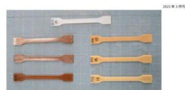
図1 試作したJIS1A型試験片
