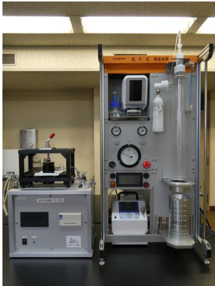
マスク性能試験装置 設置場所：【繊維工業試験場】
