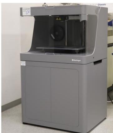
本装置は3次元データを用いて立体モデルを造形する装置です。意匠確認や試作、治具の作成等、幅広い分野で迅速な製品開発に活用されます。長繊維ファイバー材を積層することで実用できる高い強度を有する立体モデルを造形できます。
