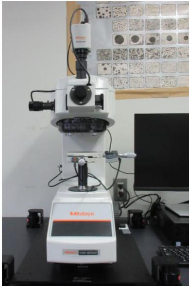
試料表面にダイヤモンド圧子を押し込み、押し込み時に生じるくぼみの大きさを測ることにより硬さを評価する試験機です。試験荷重が低荷重まで対応していることから薄膜等の微小領域の硬さが測定可能です。ビッカース硬さ及びヌープ硬さ測定に対応します。
