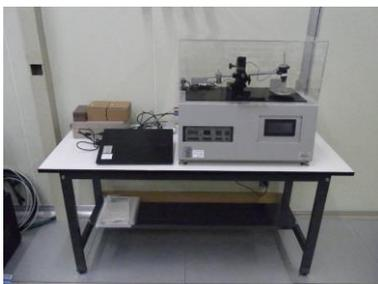
摩擦摩耗試験機は、2つの物体を接触、摺動させることで試験体を摩耗させ、摺動時の摩擦力等を測定する装置です。
