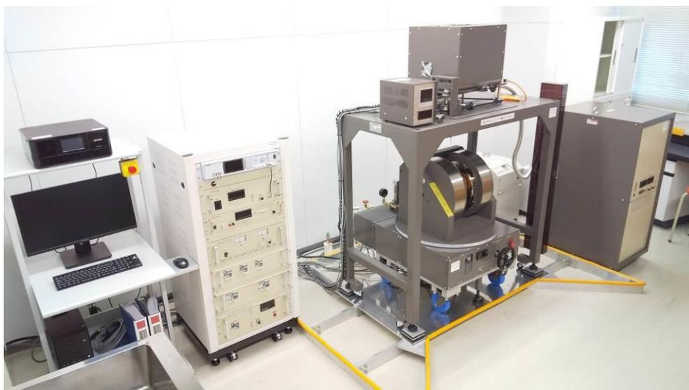
高感度振動試料型磁力計
