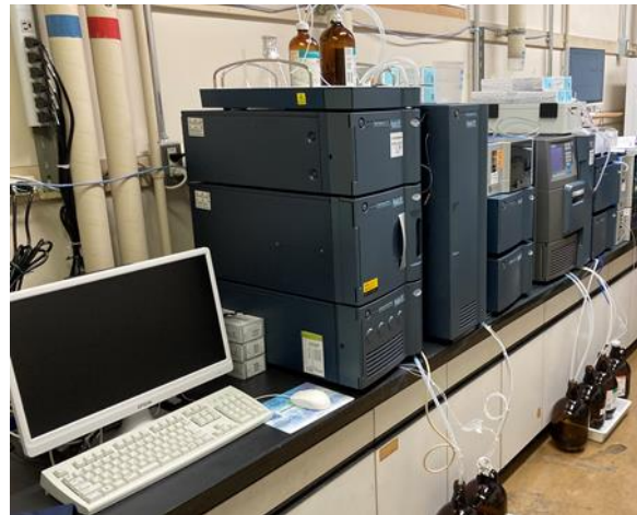
高分子絶対分子量測定装置システム 全景
