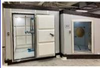
図1 吸音率・音響透過損失測定装置
