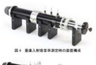
図4 音源入射吸音率測定時の装置構成
