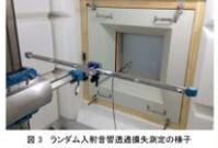
図3 ランダム入射音響透過損失測定の様子
