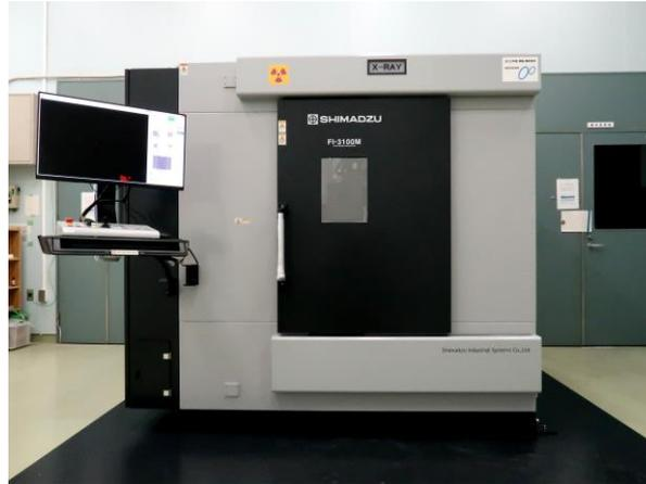
エックス線非破壊検査装置
