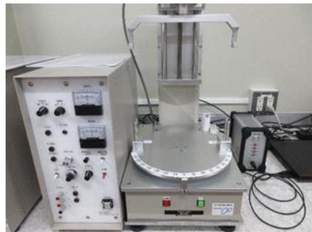
本装置は、表面をなでる、引張る、折り曲げる、指で押すといった動作を試験機上で再現し、客観的な数値として評価を行う機器である。
