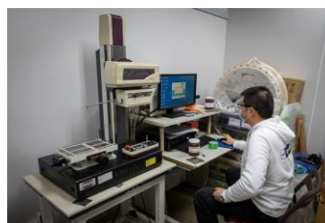
図4 加工形状の測定
