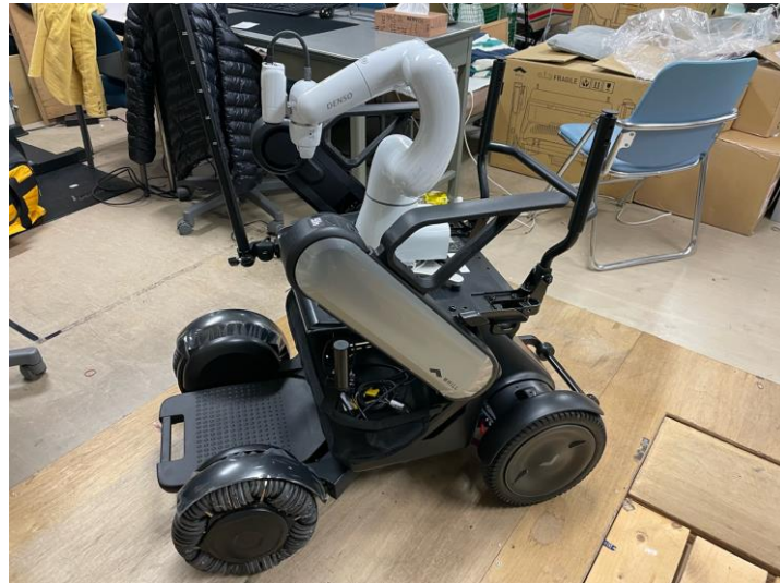
図13 統合型AR制御移動マニピュレータシステム
