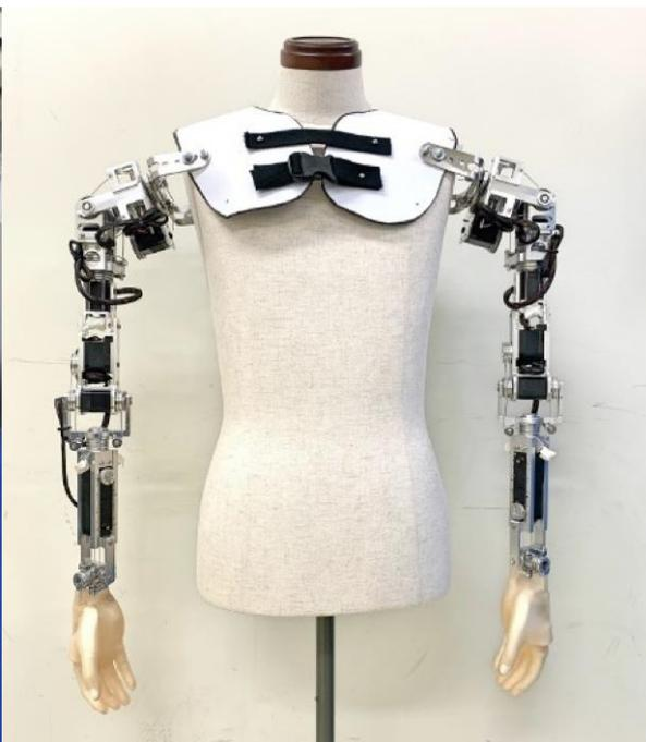
図2:開発した装着型7自由度ロボットアーム
