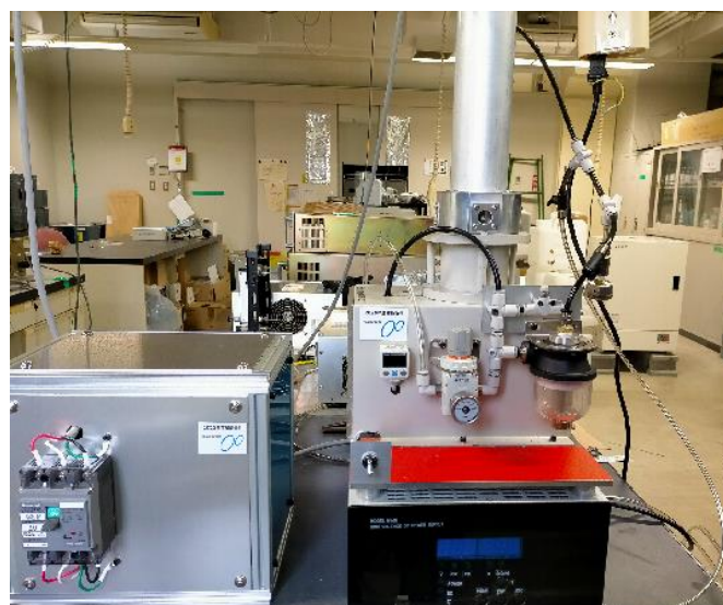
写真2：汎用型液中プラズマ装置(最大出力2kW)：装置価格原価：90万円
