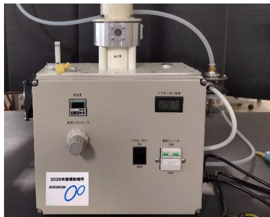
写真1：卓上型液中プラズマ装置（最大出力200W）：装置価格原価：50万円
