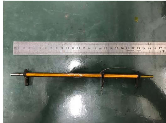
図2 衛星構造と一体化させた磁気姿勢アクチュエータ
