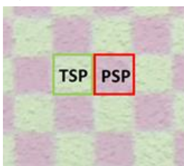
図4 作成された複合PSP/TSPセンサ(左)と光励起されたサンプル(右)
