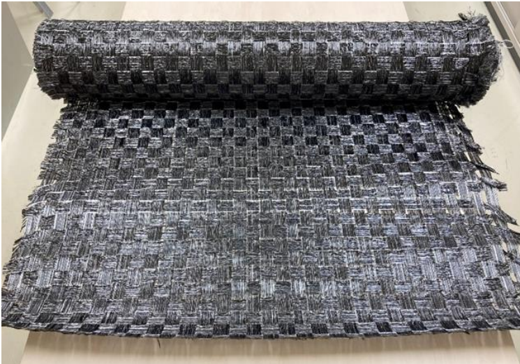
図3 開織コミングルヤーン平織物プリプレグシート
