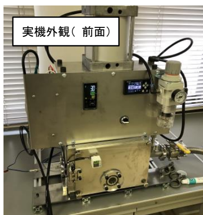
<改修前の拡散接合装置>
