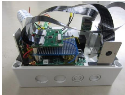
図2 カメラ・通信ユニットをもつコンピュータユニット
