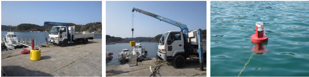
図4 ブイおよび波浪計測機器設置の様子
