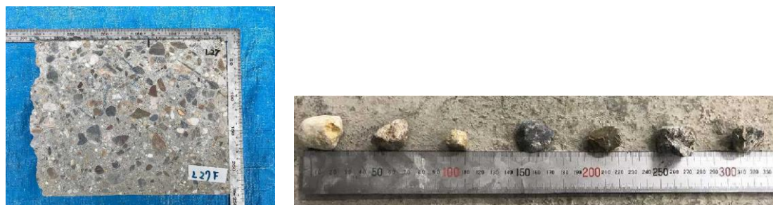
図1 コンクリート断面の骨材（左）と実際の骨材（右）
