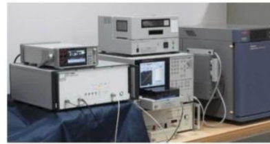
導入したパワーアンプとB-Hアナライザー式
