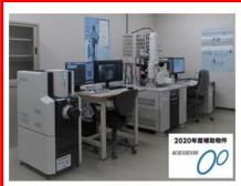
多機能走査型電子顕微鏡システム
