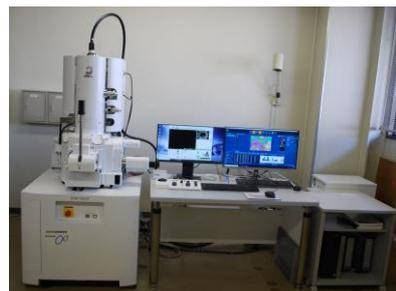
分析機能付超高分解能走査電子顕微鏡
