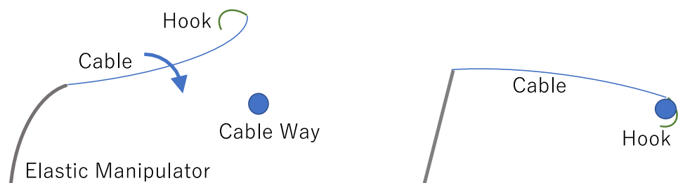
(a) 索道および副索道となるワイヤの投擲 (b) 投擲後の既存索道との接続
