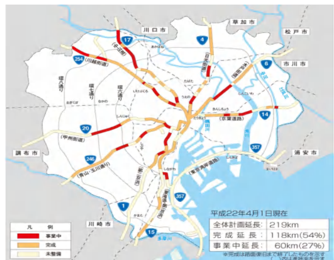
図 3.3-4 東京中心部の電線共同溝整備状況
