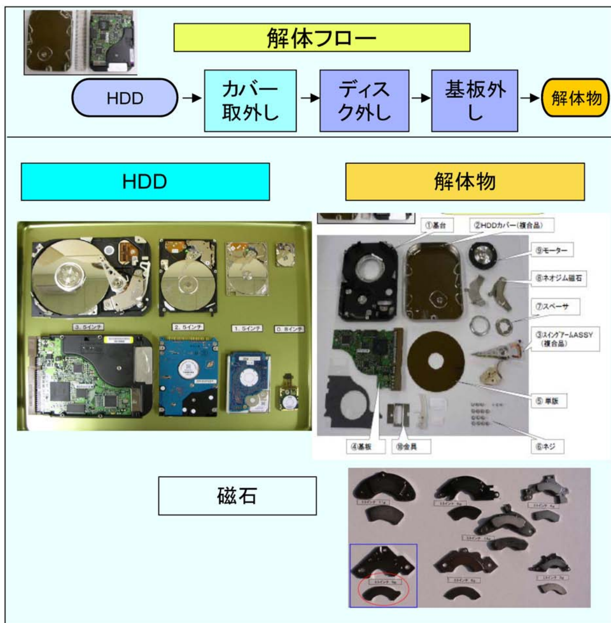
図 4.7 解体されたハードディスクと磁石の形状
