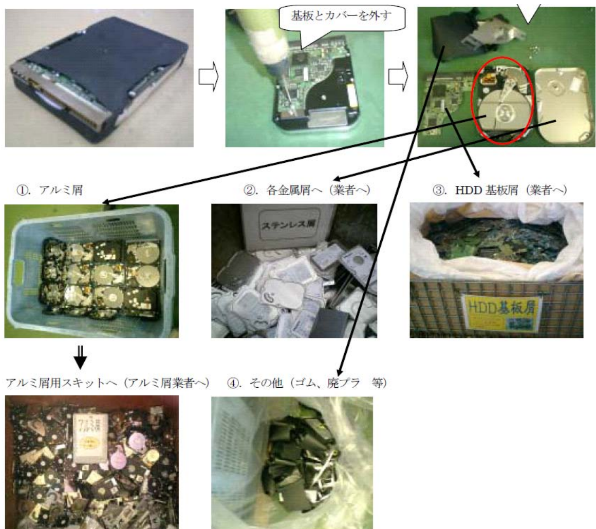
図 4.6 ハードディスク解体事例
