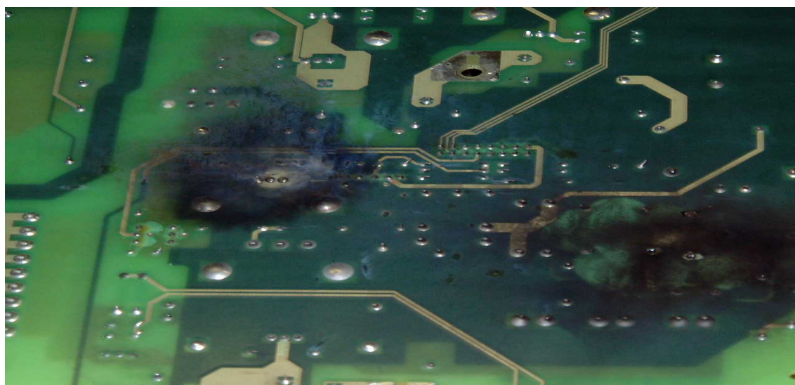
図 3.88 ジンクウィスカの影響を受けた部品
