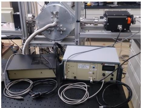
真空紫外吸収分光法の計測システム
