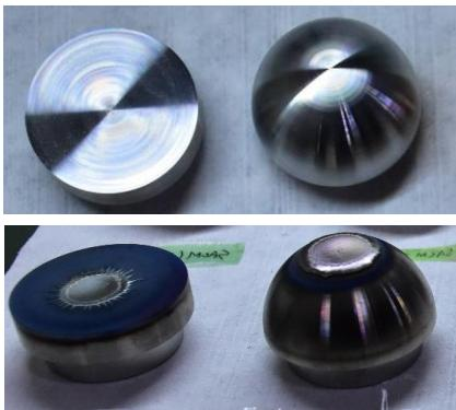
窒化鋼供試体(上:加熱前、下:加熱後)
