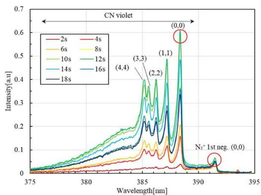
供試体表面の発光スペクトルの時間変化
