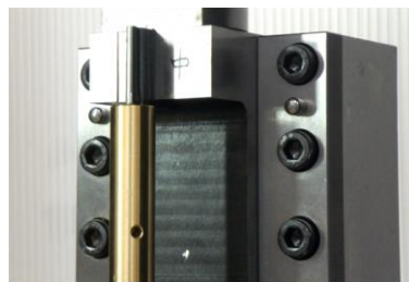
ブローチ加工用特殊工具による加工実験
