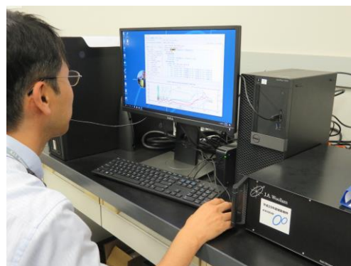
図2 分光エリプソメーターによる膜の光学特性評価および解析
