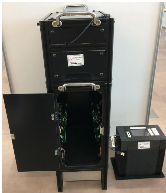
図4. 紙幣真偽識別器(左)とその小型軽量化(右)
