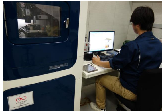
図2 ナノインデンターによる膜の 高温特性評価および解析
