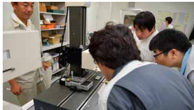
試料表面の粗さを測る「面粗さ測定機」を真剣に覗き込む
