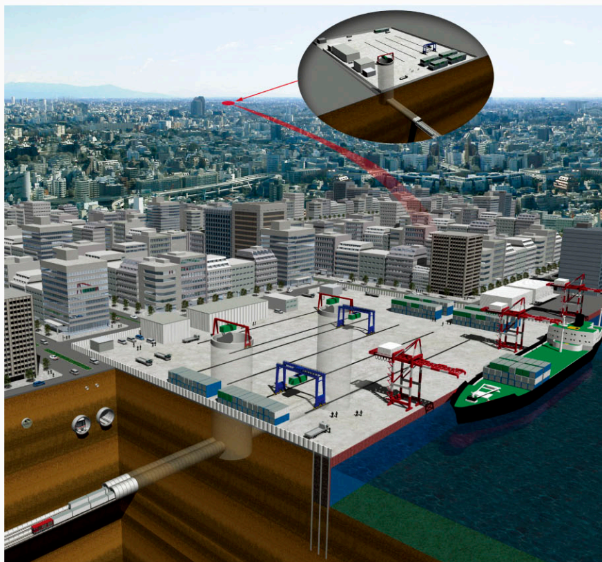
東京港の大井埠頭から青梅までをつなぐ、大深度地下を利用した物流トンネルのイメージ図
