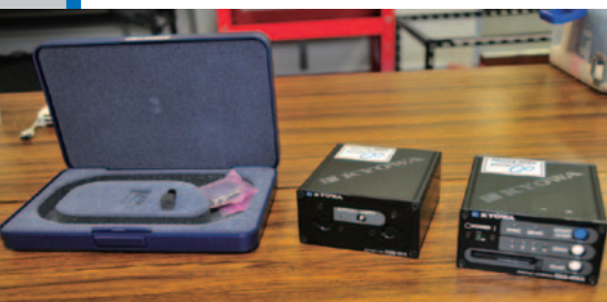
この研究のため、競輪補助事業で購入した機器。ひずみ、電圧測定ができる「コンパクトレコーダ」(右)と、一度に3方向の計測ができる「3軸加速度センサ」(左)。
