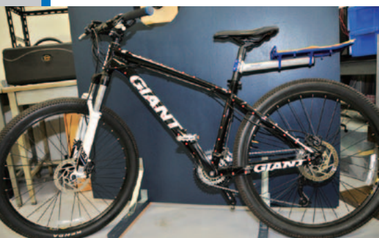
実験に使ったマウンテンバイク。フレーム部分に3軸加速度センサとコンパクトレコーダを付け、振動特性を計測。
