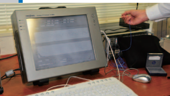
パソコンのような形をしたFFTアナライザで振動の波形を解析する。
